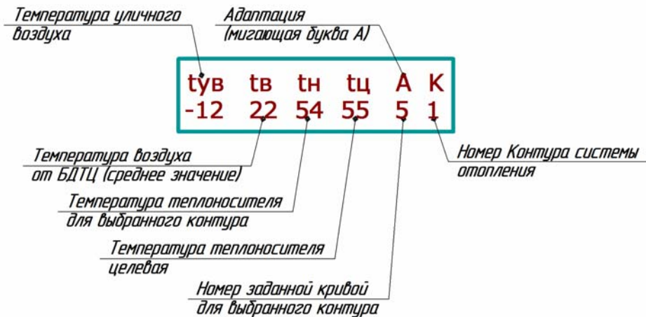
Фигура 2. Пояснения к окну и параметрам системы отопления
